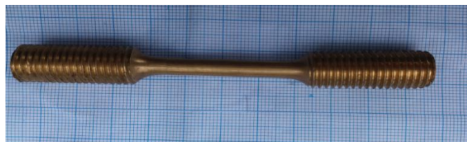
Gambar 3.8 Spesimen Statis Kuningan
