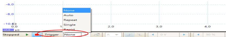
Gambar 3.23 Penyetelan Trigger None
