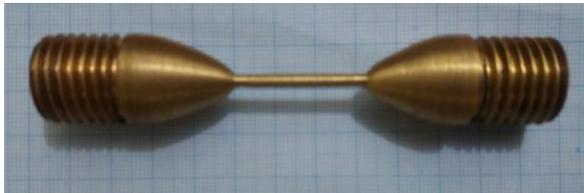
Gambar 3.10 Spesimen Dinamik Kuningan
