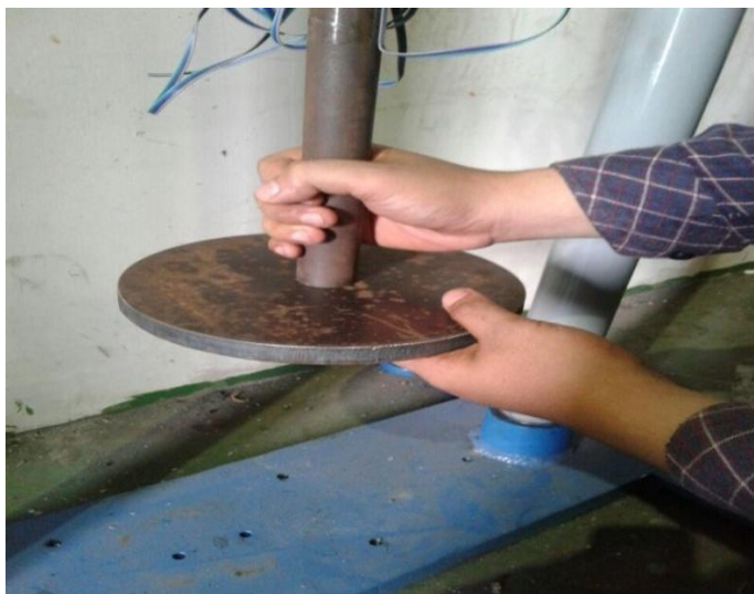
Gambar 3.12 Pemasangan Plat Stopper
