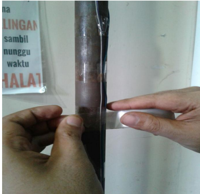
Gambar 3.13 Pemasangan Kabel Strain Gages
