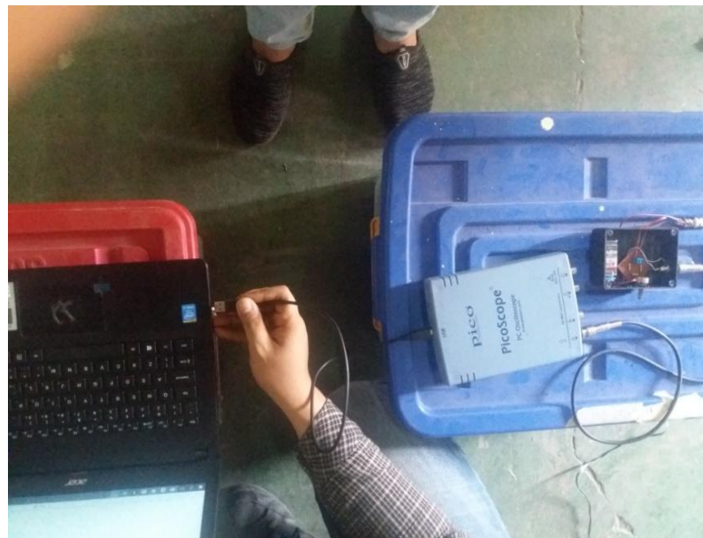
Gambar 3.16 Pemasangan Output Picoscope Pada PC (laptop)
