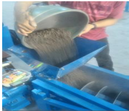
Gambar 3.25. Memasukkan Material Kedalam Corong ( hopper )
