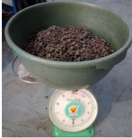
Gambar 3.27. Penimbang Massa Akhir Material
