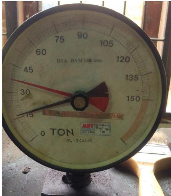
Gambar L 13: Uji kuat tekan beton campuran abu 5% 7 hari: 37,5 T
