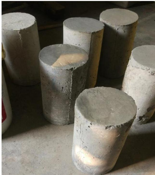
Gambar L10: Benda uji yang di jemur.
