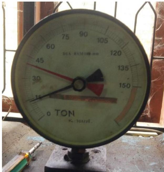
Gambar L 14: Uji kuat tekan beton campuran abu besi 10% 7 hari: 40,5 T
