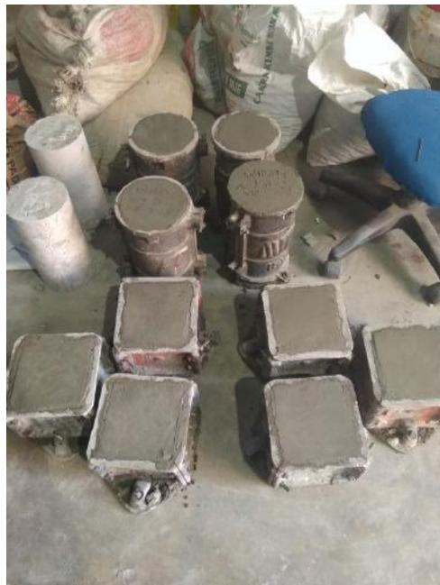
Gambar L8: Proses pencetakan beton.
