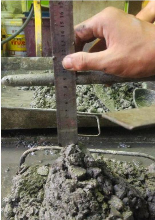
Gambar L7: Proses pengujian *slump*.
