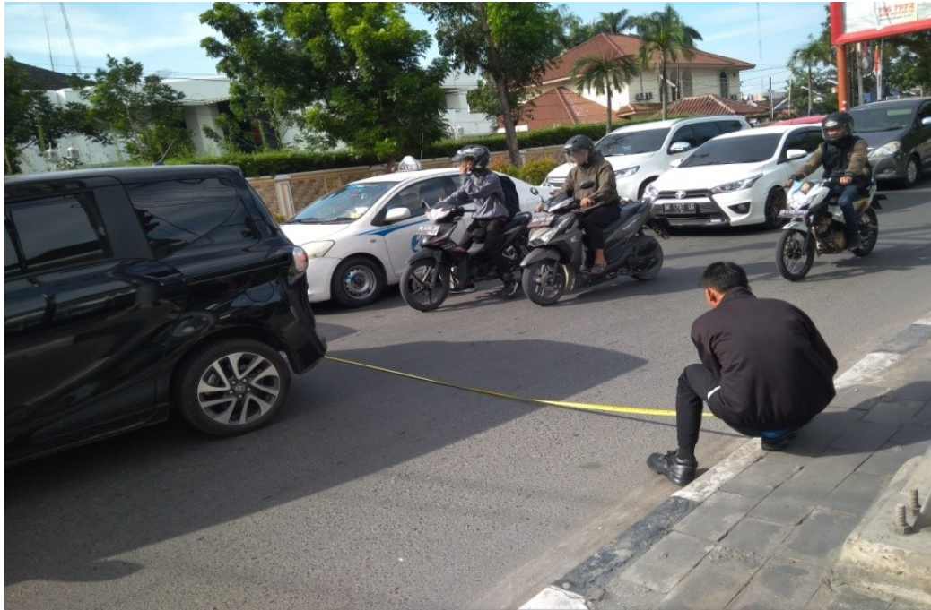
Gambar L1: Proses pengukuran lebar jalan.
