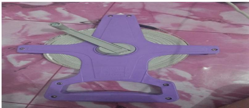
Gambar L11: Meteran rol, peralatan yang digunakan untuk mengukur penggal pengamatan pada saat survei
