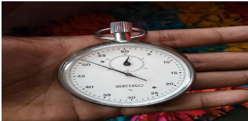
Gambar L10: Stopwatch, peralatan yang digunakan untuk mengetahui waktu tempuh pejalan kaki pada saat survei
