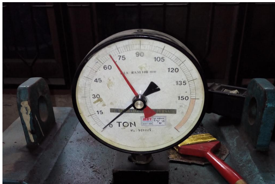
Gambar L11: Uji kuat tekan beton dengan abu arang mangrove 28 hari: 67,5 T
