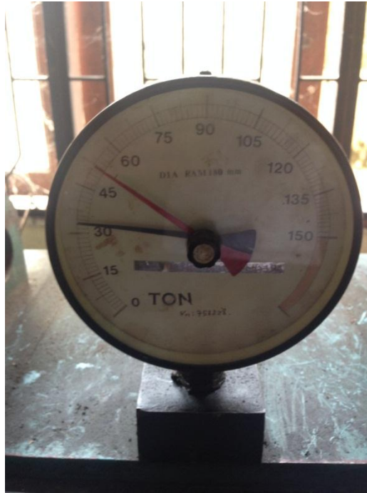
Gambar L11: Uji kuat tekan beton campuran serbuk arang kayu 15%
