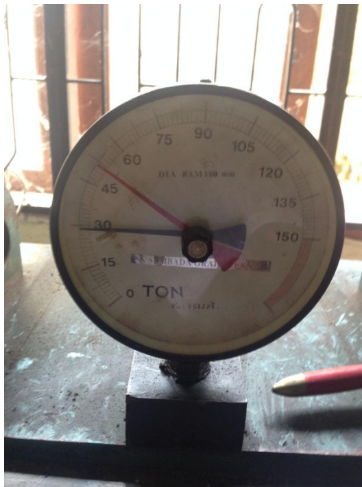
Gambar L10: Uji kuat tekan beton campuran serbuk arang kayu 10%
