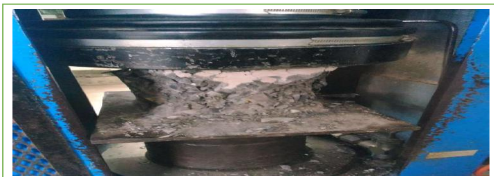
L6: Setelah proses pengujian kuat lentur dan kuat tekan.
