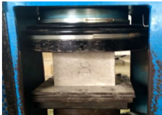
Gambar 4.1: Beban tekan pada benda uji kubus.
