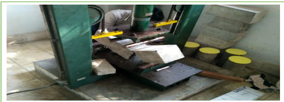
L5: Setelah proses perawatan masuk proses pengujian lentur mulai dari benda uji diberi tanda lalu ditimbang kemudian diuji lentur.
