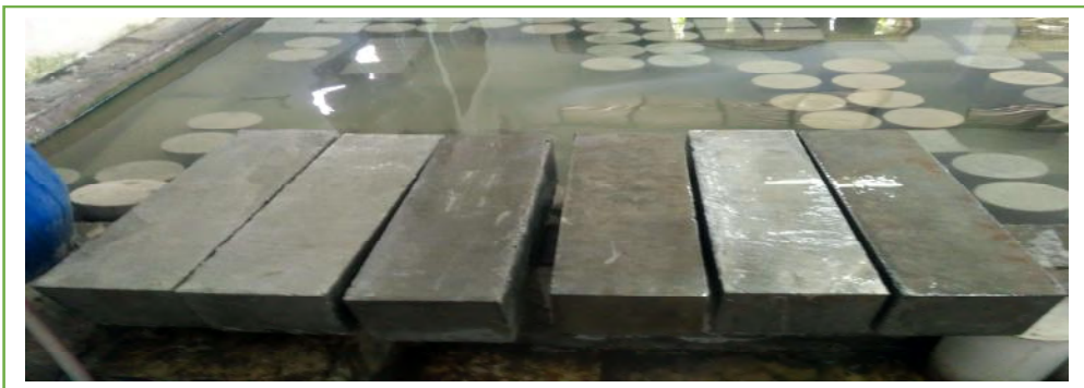
L4: Proses setelah pencetakan benda uji sampai dengan pengangkatan benda uji dari proses perawatan benda uji.
