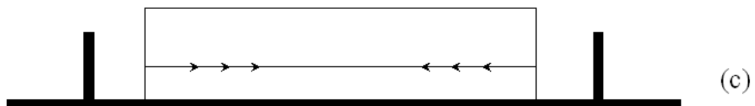
Gbr c. Pentransferan tegangan baja ke beton
