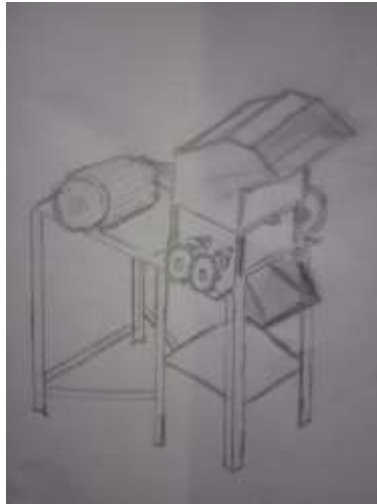
Gambar 4.2: Konsep kedua desain mesin Pencacah limbah botol plastik dan softdrink
