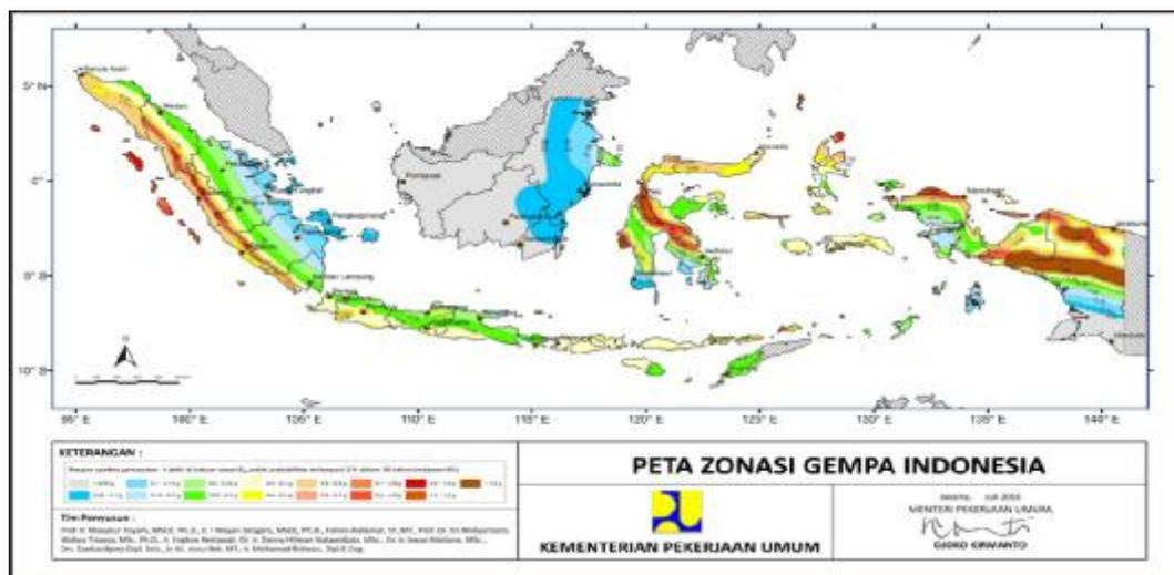
Gambar 2.15: Peta respon spektra percepatan 1 detik di batuan dasar  $s_b$  untuk probabilitas terlampaui 2% dalam 50 tahun (redaman 5%). Kementerian pu tahun 2012.
