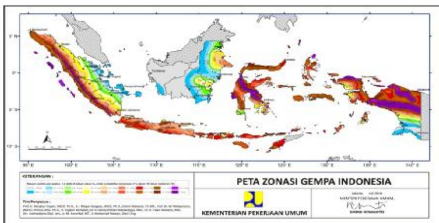
Gambar 2.14: Peta respon spektra percepatan 0,2 detik di batuan dasar  $s_b$  untuk probabilitas terlampaui 2% dalam 50 tahun (redaman 5%). Kementerian pu tahun 2012.
