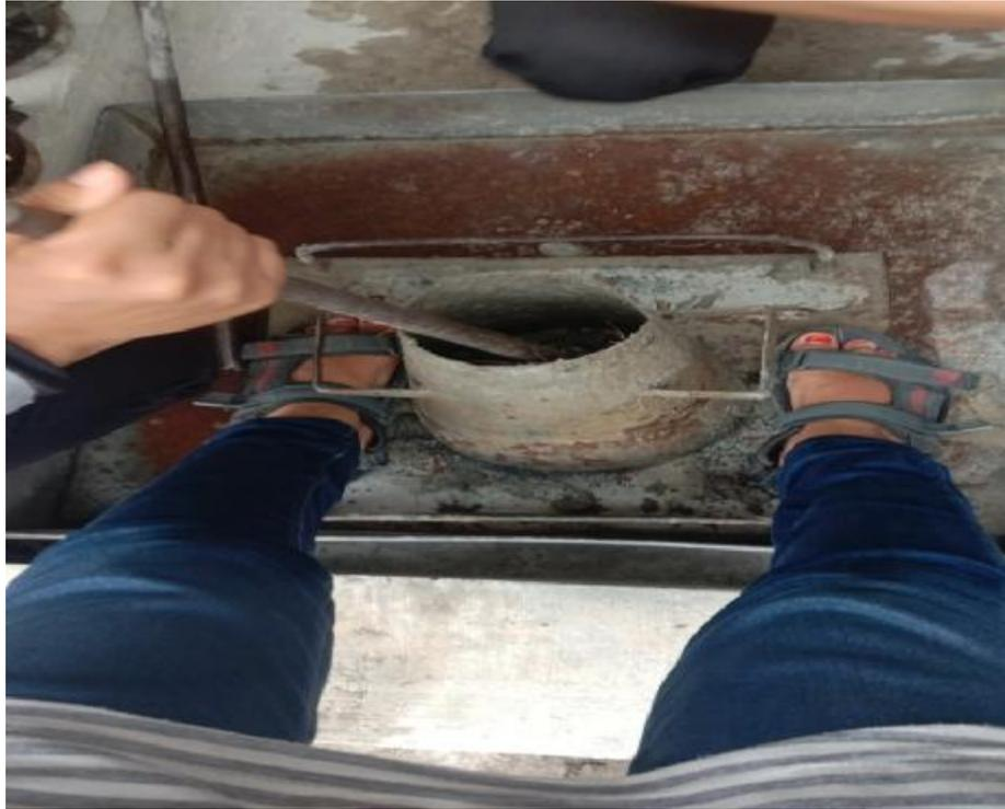
Gambar L11: Perojokan dengan menenggunakan besi pematat.
