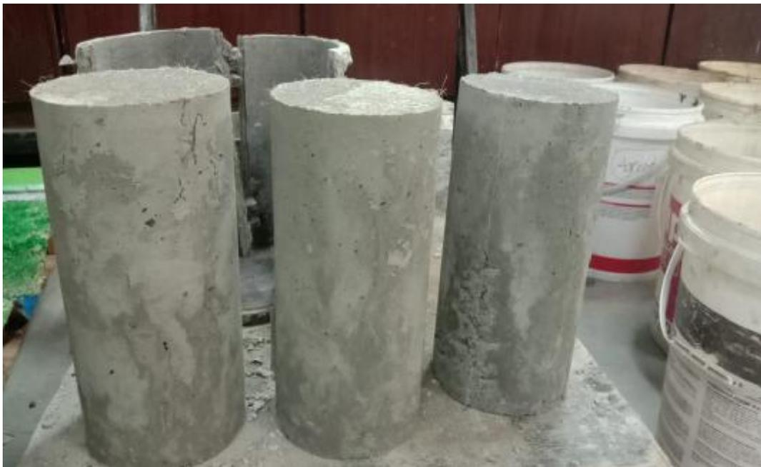
Gambar L18: Beton yang telah dibuka dari cetakan.
