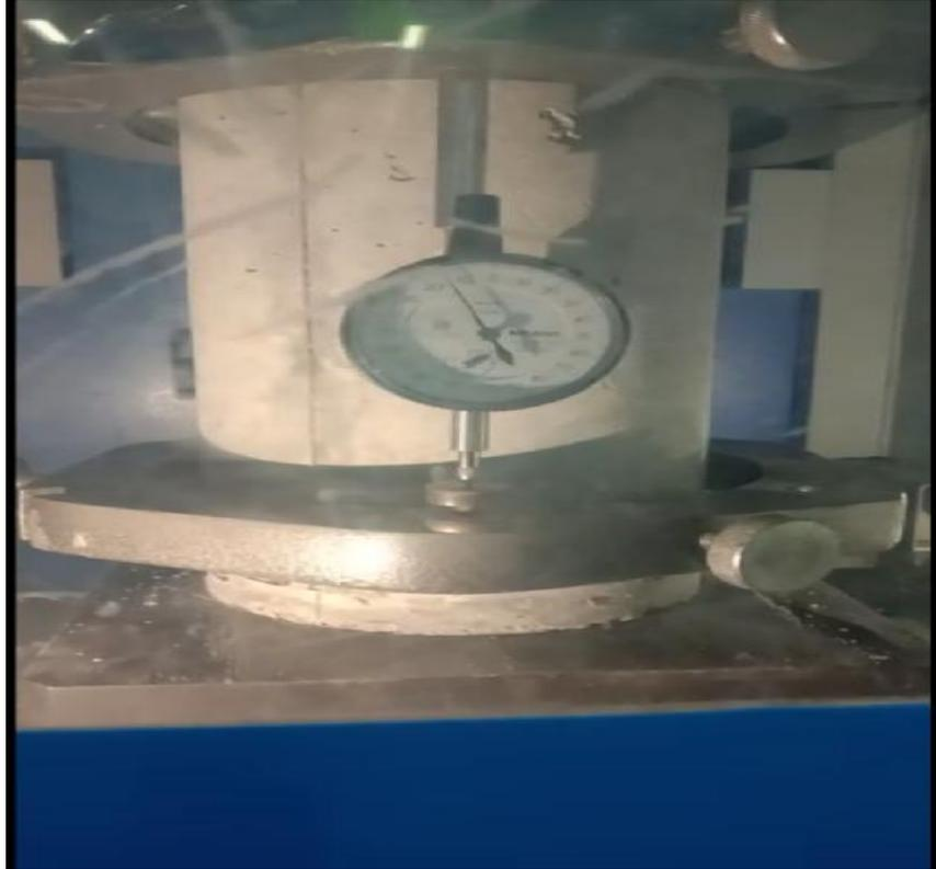
Gambar L21: Pengujian kuat tekan beton.
