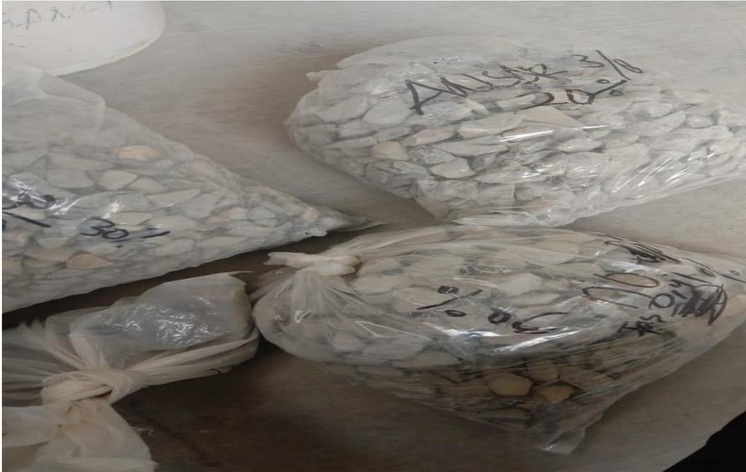
Gambar L1: Agregat kasar untuk campuran beton.
