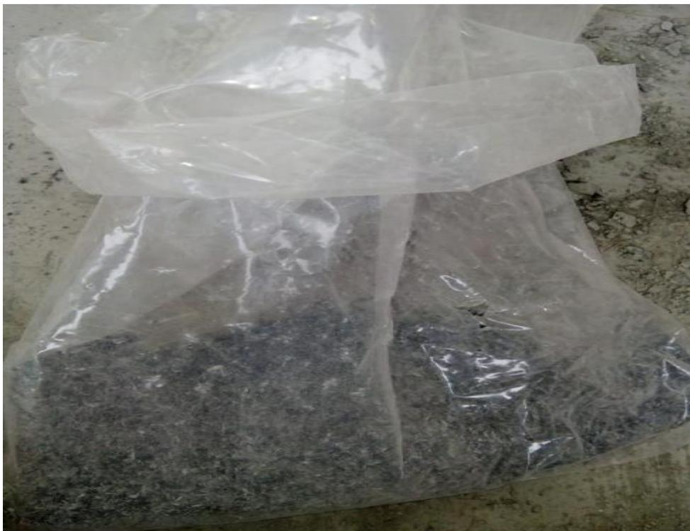
Gambar L8: Abu sekam padi yang akan digunakan pada campuran beton.
