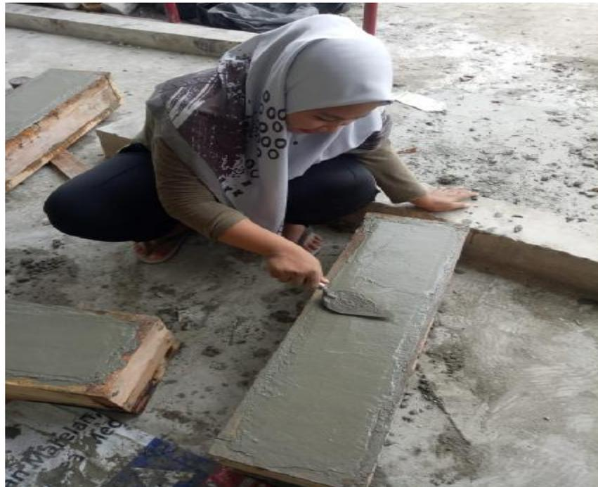
Gambar L22: Proses pembuatan beton prisma untuk *flexural*.
