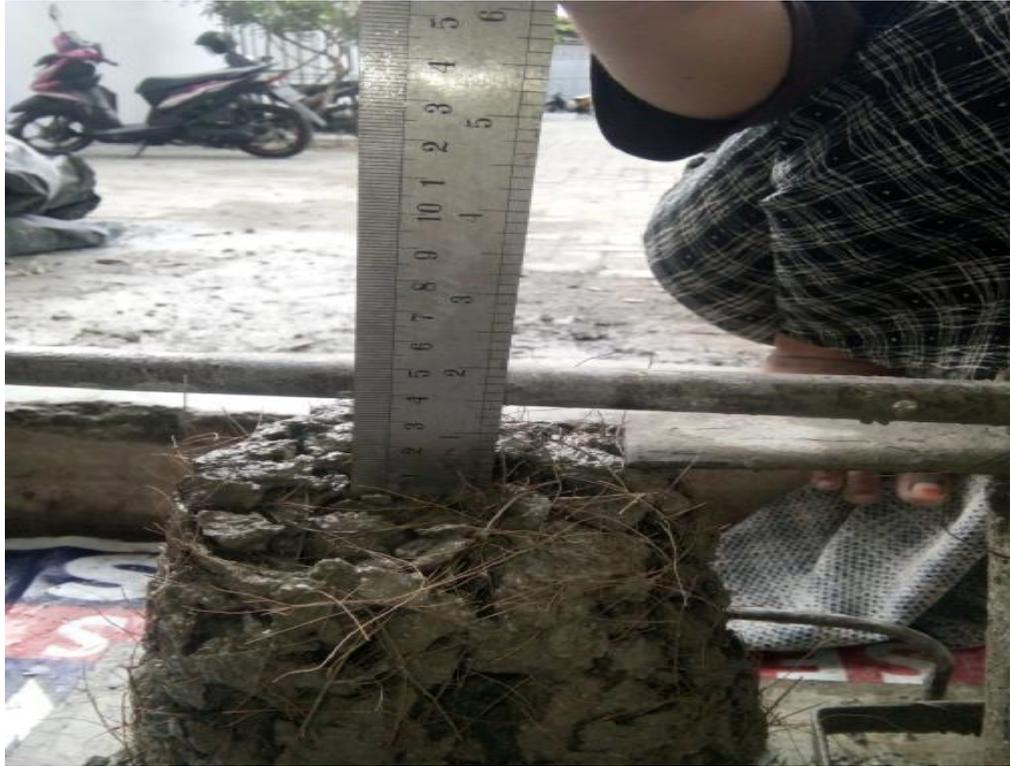
Gambar L13: Pelaksanaan pengukuran tinggi *slump* pada beton dengan fas 0,41.
