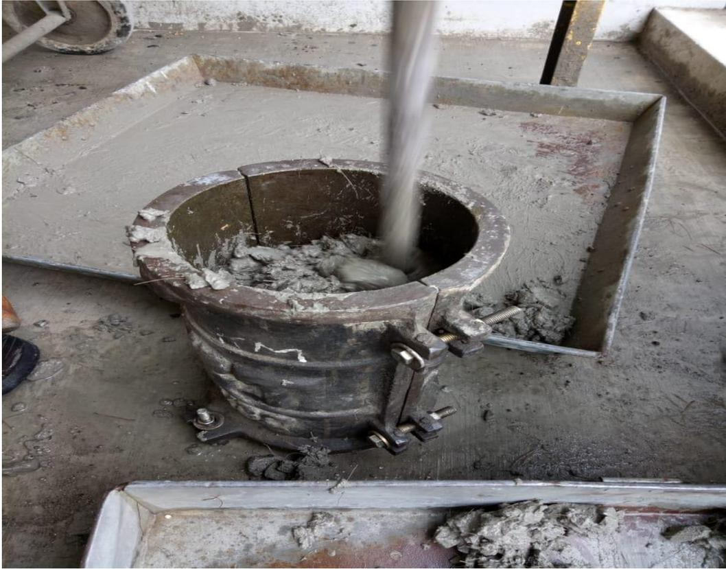
Gambar L15: Perojokan dengan menggunakan besi pematik.
