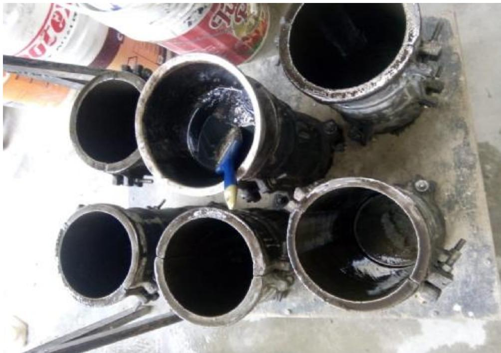
Gambar L14: Cetakan silinder untuk mencetak benda uji.
