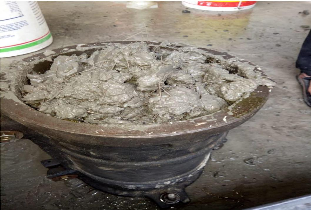
Gambar L16: Pencetakan beton di cetakan silinder setelah di *mixer*.
