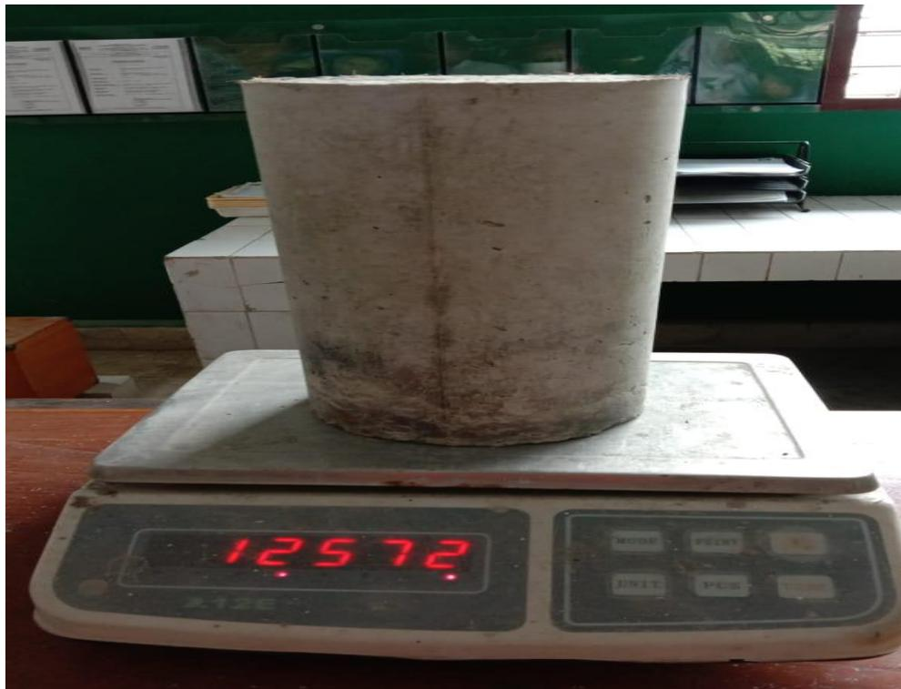
Gambar L20: Beton ditimbang sebelum di uji kuat tekan.
