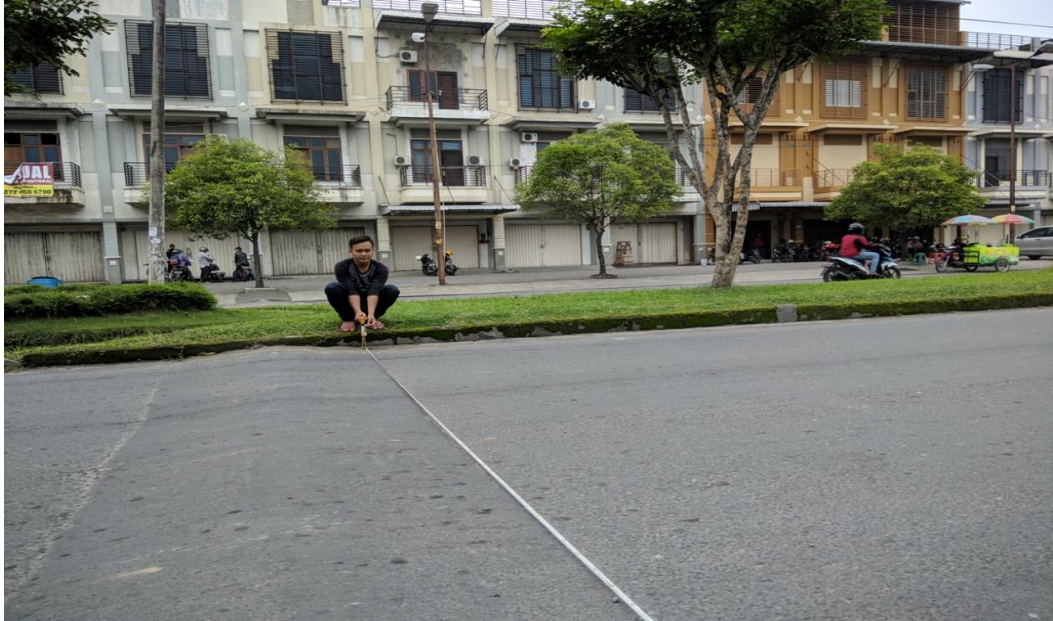
Gambar L.1: Mengukur lebar jalan.
