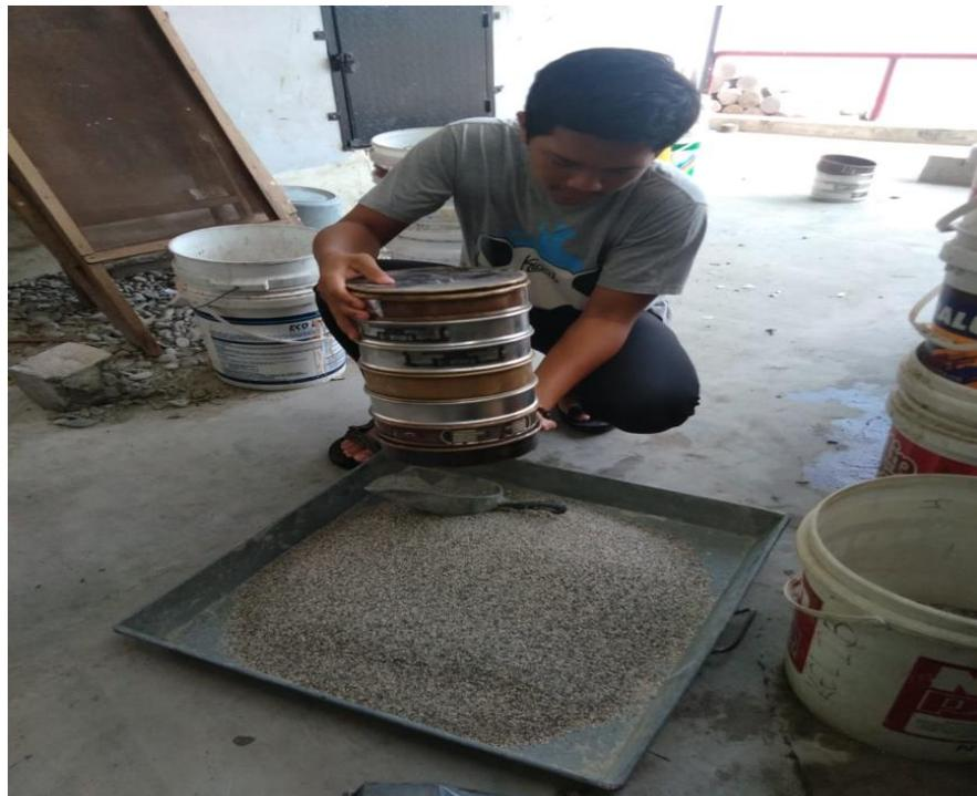
Gambar L4: Pengayakan agregat yang akan digunakan.
