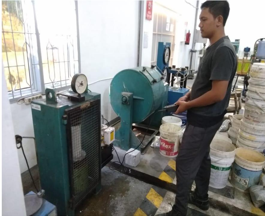
Gambar L19: Proses pengujian kuat tekan beton dengan mesin compression testing.
