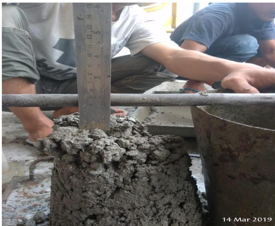
Gambar L25: *Slump test* beton kaca 8% 14 hari sebesar 3,5 cm.
