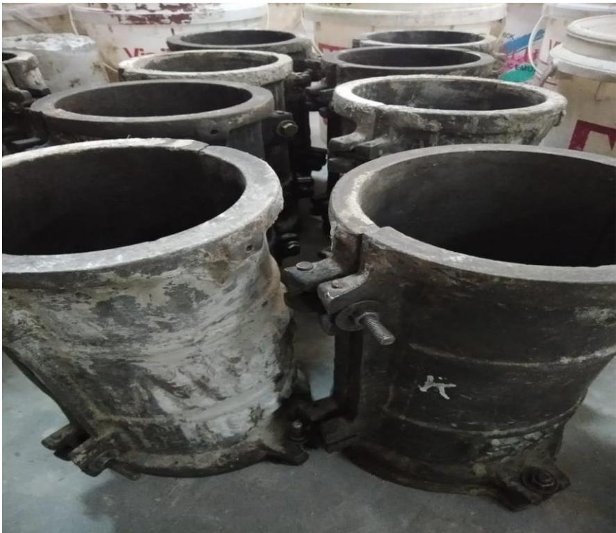
Gambar L14: Cetakan silinder 15 cm × 30 cm.
