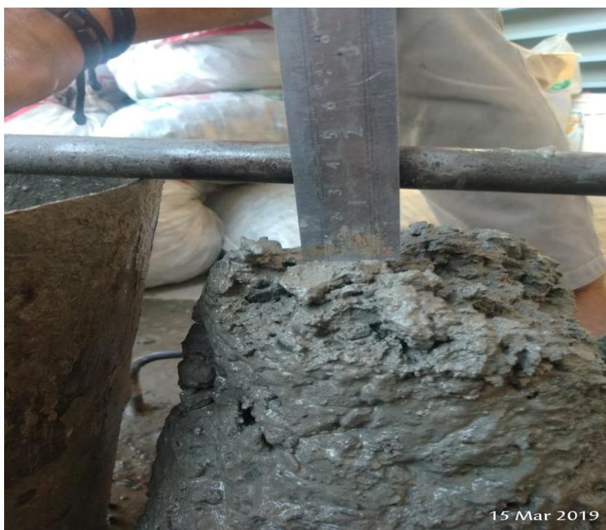
Gambar L64: *Slump test* beton marmer 10% 28 hari sebesar 4 cm.
