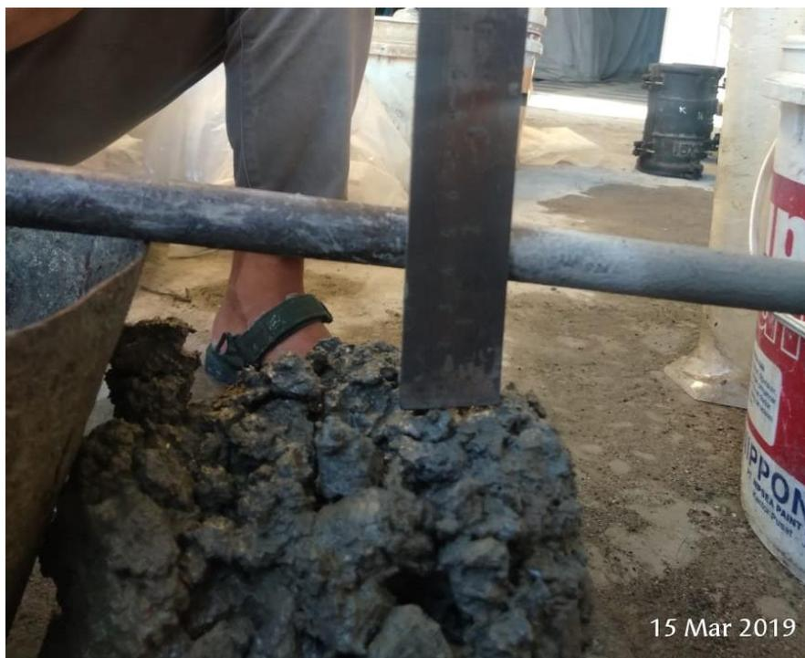
Gambar L63: *Slump test* beton normal 28 hari sebesar 4 cm.
