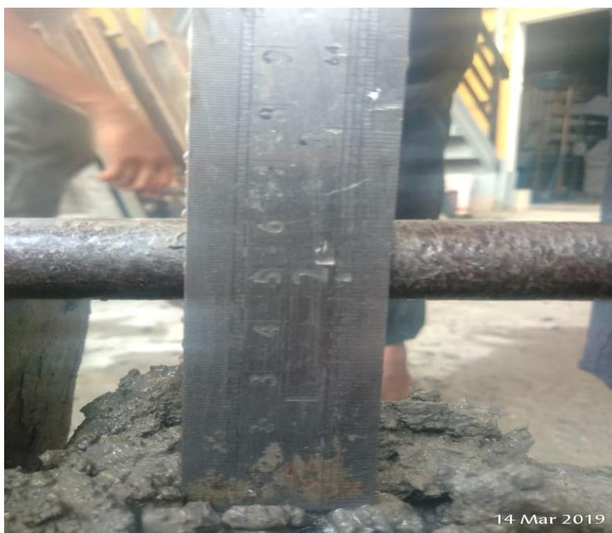
Gambar L26: *Slump test* beton marmer 10% + kaca 8% 14 hari sebesar 4,5 cm.
