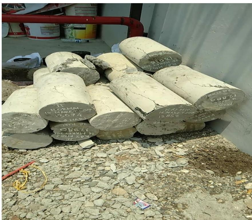
Gambar L22: Beton 28 hari setelah di uji kuat tekan.
