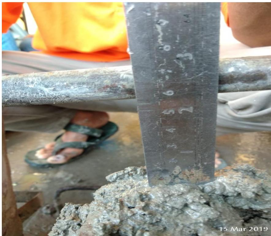
Gambar L66: *Slump test* beton marmer 10% + kaca 8% 28 hari sebesar 5,5 cm.
