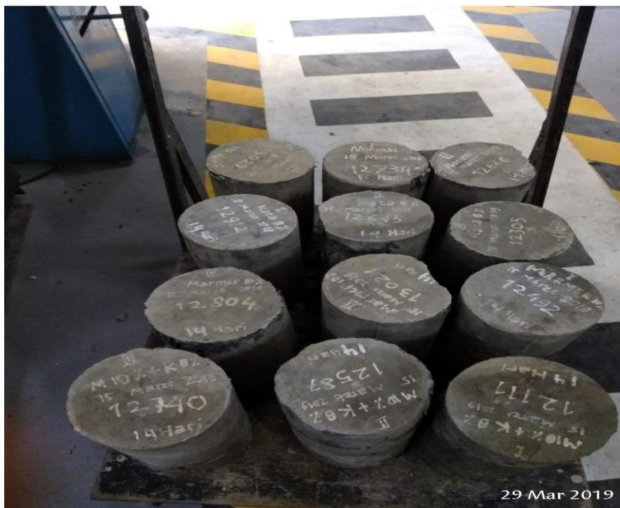
Gambar L21: Beton 14 hari setelah di uji kuat tekan.
