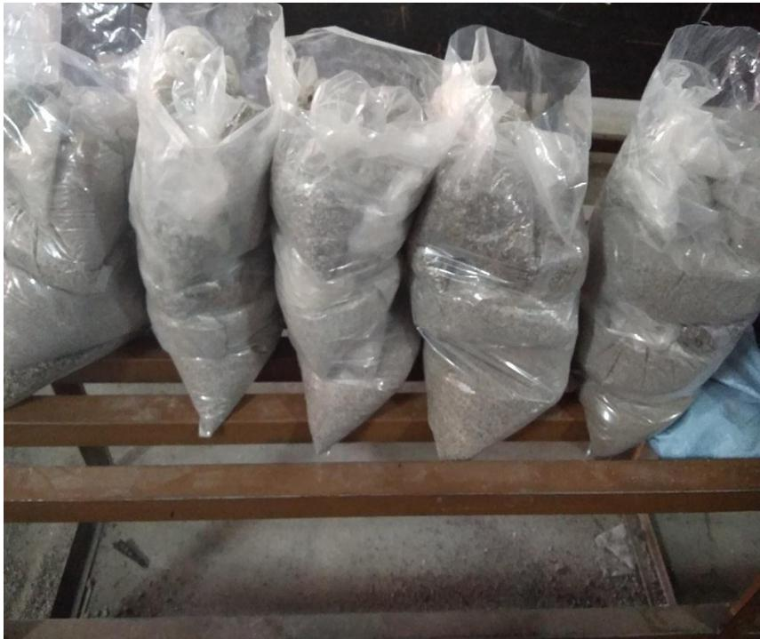
Gambar L6: Agregat halus yang sudah di ayak.
