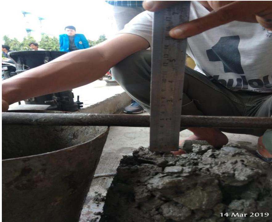
Gambar L23: *Slump test* beton normal 14 hari sebesar 3,8 cm.
