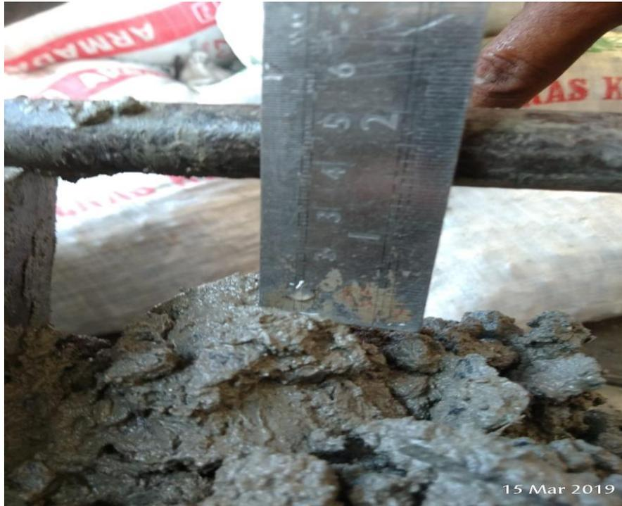
Gambar L65: *Slump test* beton kaca 8% 28 hari sebesar 3,7 cm.
