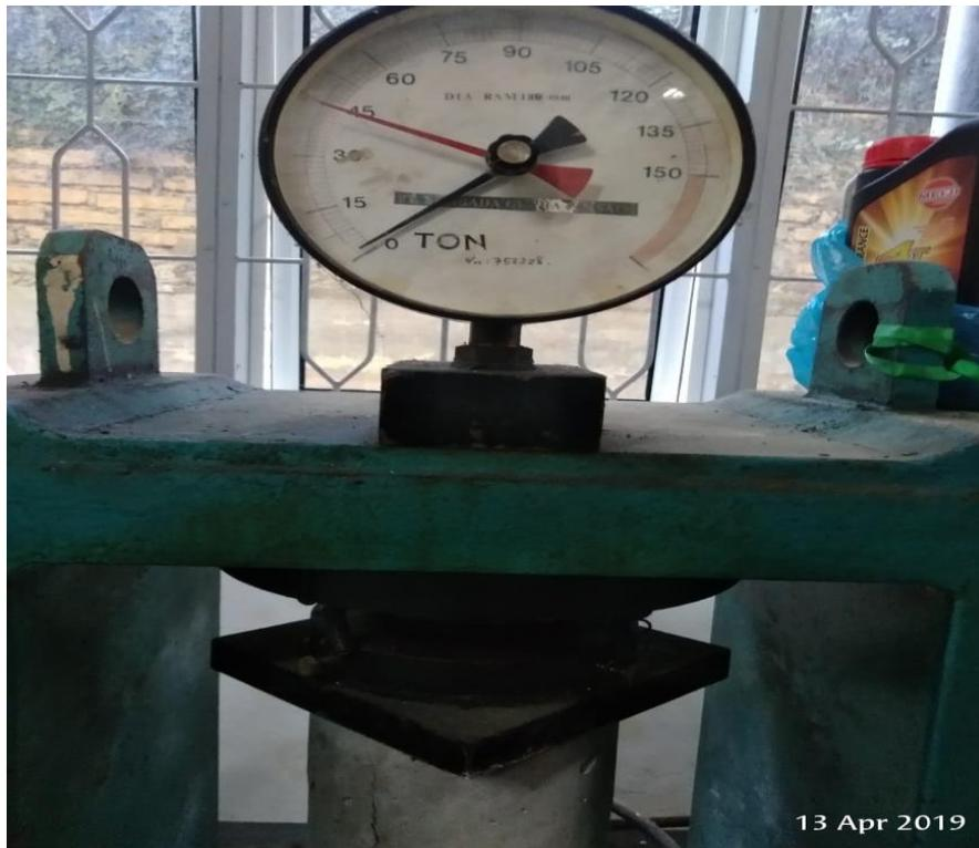
Gambar L20: Hasil pengujian kuat tekan beton.
