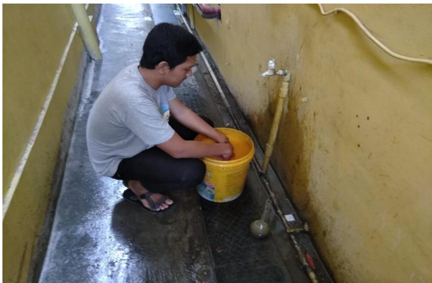
Gambar L2: Pencucian agregat yang akan digunakan.
