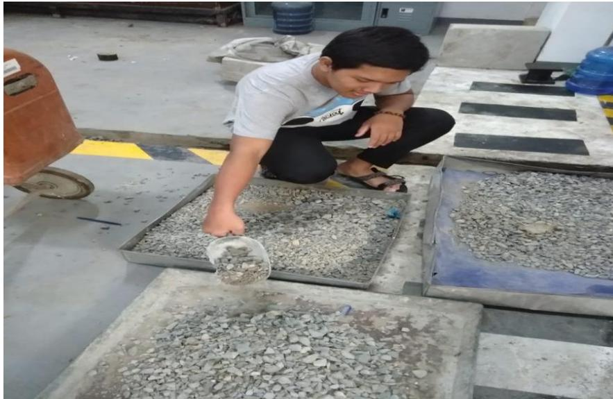
Gambar L1: Pengambilan material untuk dicuci.
