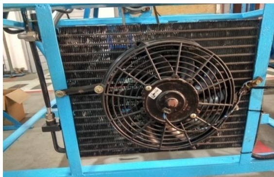
Gambar 2.3 Kondensor AC Mobil sumber : Lab UMSU 2019
