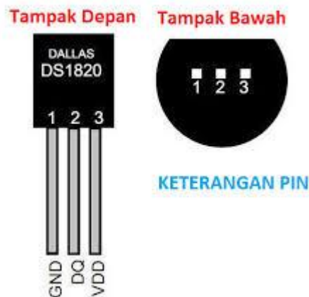
Gambar 2.14 Bentuk Fisik Sensor Temperatur DS18B20 (Sumber : https://kl801.ilearning.me , 2105)
