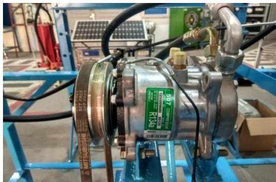
Gambar 2.2 Kompresor AC mobil (Sumber :Lab UMSU 2019.)
