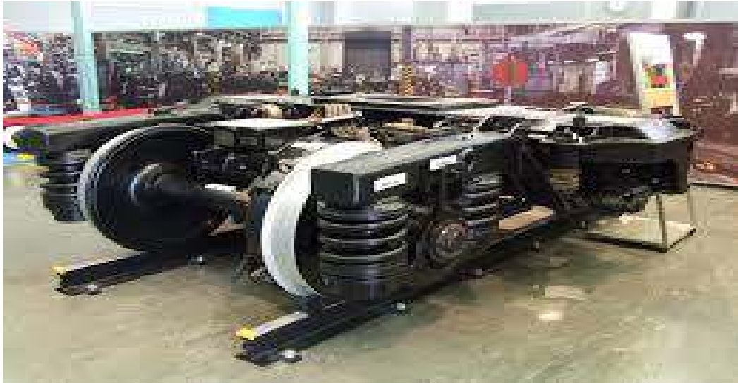
Gambar 2.6: Bogie TB-398 yang termasuk tipe K-5(Peraturan Menteri Perhubungan Republik Indonesia nomor: KM 31 tahun 2011)..
