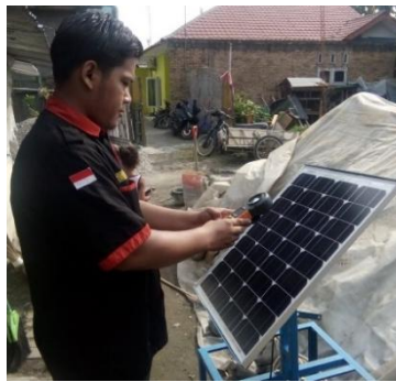
Gambar 3.30 Mengukur Intensitas Matahari
