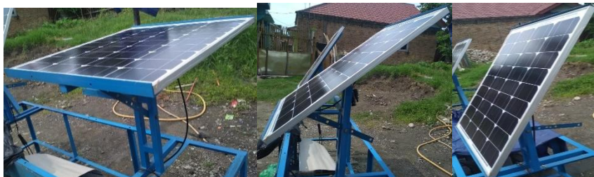
Gambar 4.1 Pengujian pengaruh arah sudut matahari terhadap keluaran sel surya arah sinar membentuk sudut tertentu.
