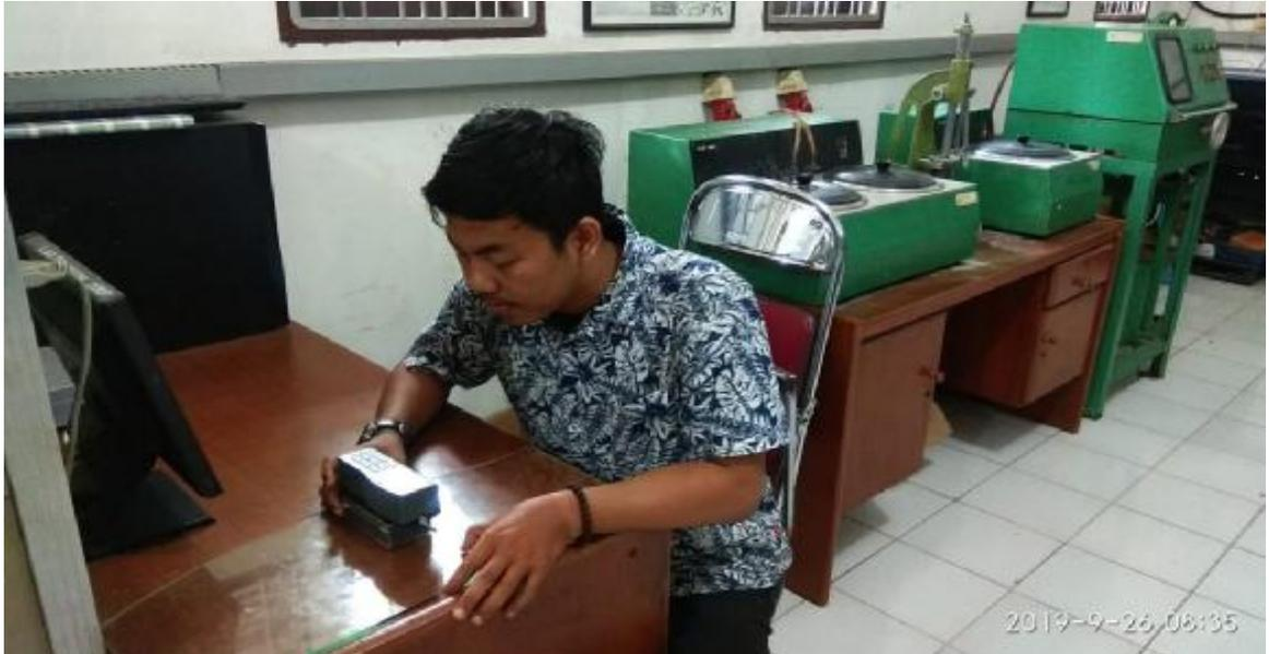
Gambar saat sedang melakukan pengujian kekasaran permukaan spesimen dengan menggunakan alat roughness test di Laboratorium Material Universitas Negeri Medan.
