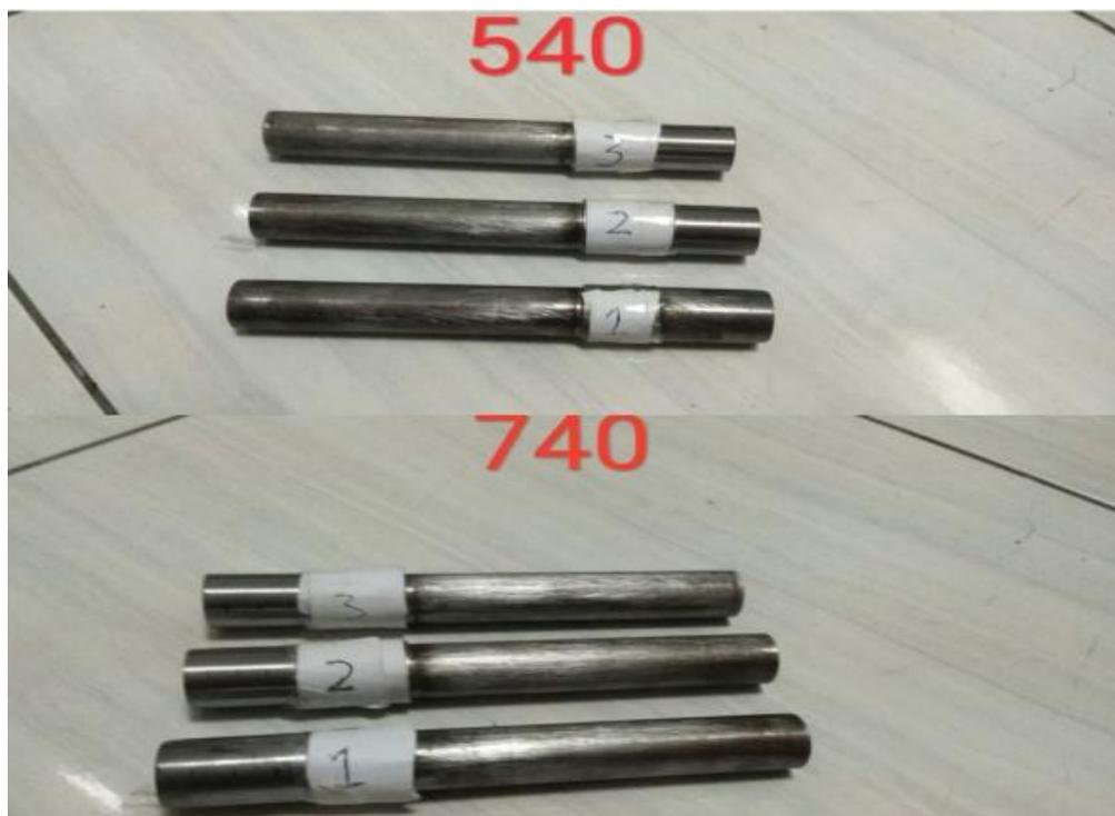
Gambar 4.11 Spesimen 0,1 0,2 0,3 mm Kedalaman Penggerindaan Pada Kecepatan Putaran Mesin 540 Rpm Dan 740 Rpm
