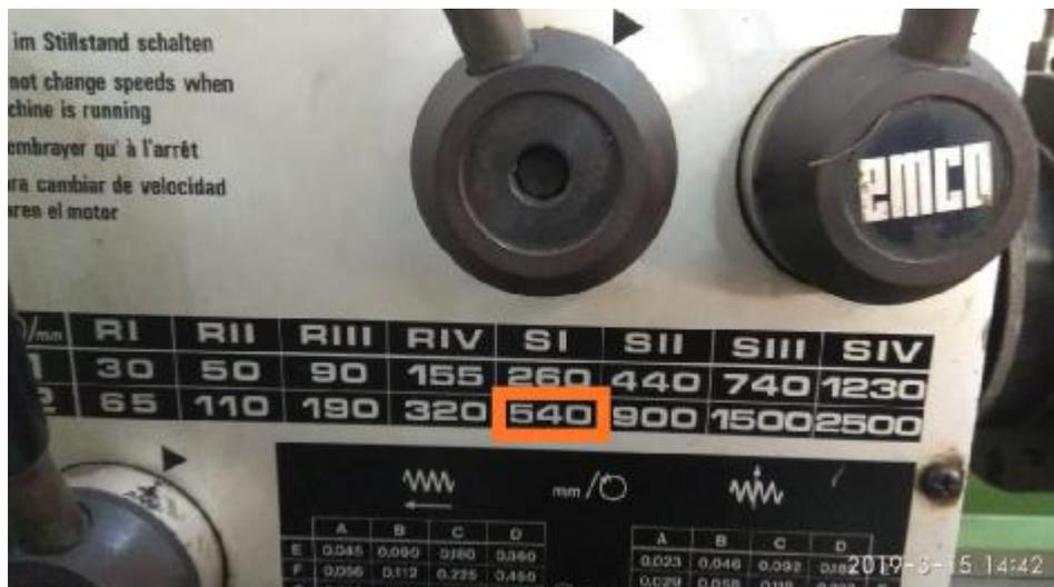
Gambar 4.4 Pengujian Dengan Kecepatan 540 rpm
