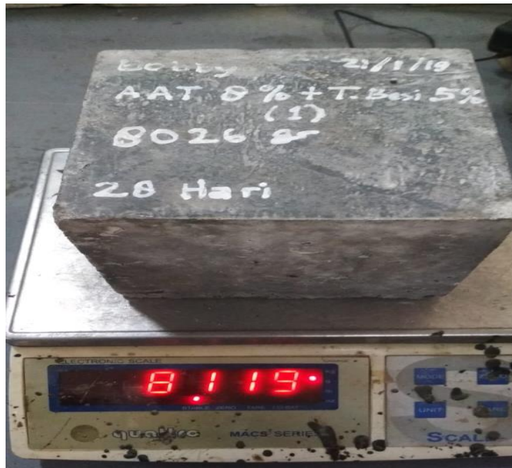
Gambar L12 : Beton sebelum di uji.
