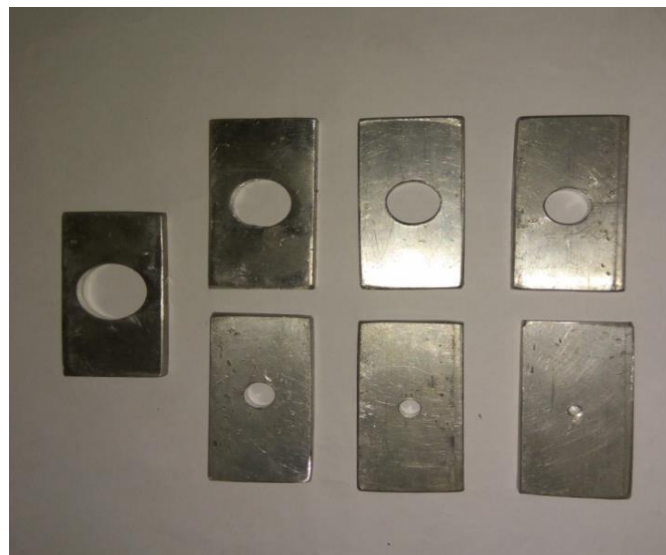
Gambar 4.3: Spesimen Alumunium Setelah dilubangi
