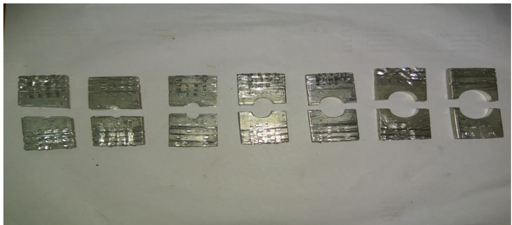
Gambar 4.5 : Spesimen Alumunium setelah dilakukan pengujian
