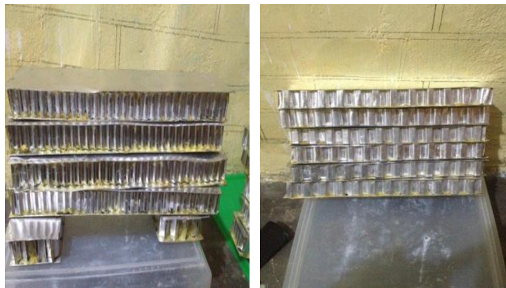
Gambar 4.2 Spesimen jenis core struktur sarang lebah
