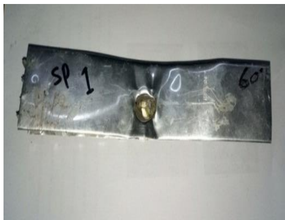
Gambar 4.6 hasil Spesimen setelah di uji dengan sudut miring 60° drajat
