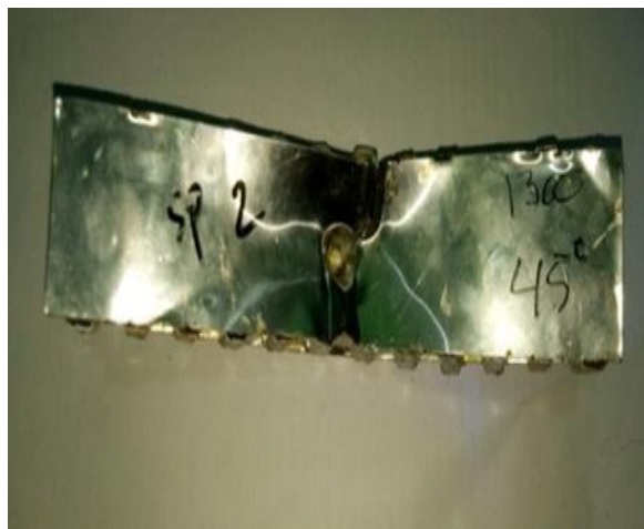
Gambar 4.8 hasil Spesimen setelah di uji dengan sudut miring 45drajat
