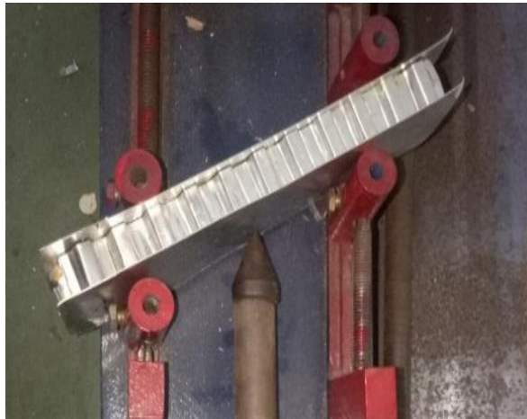
Gambar 4.7 pengukuran sudut normal 45 drajat sebelum di uji
