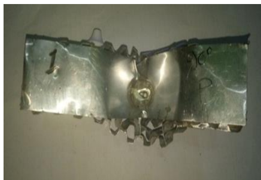
Gambar 4.4 Hasil Spesimen setelah di uji dengan sudut normal 90 drajat
