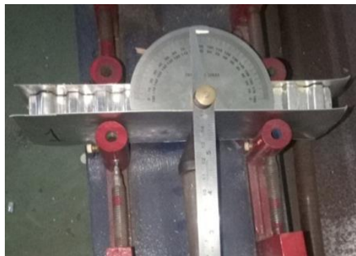
Gambar 4.3 pengukuran sudut normal 90 drajat sebelum di uji
