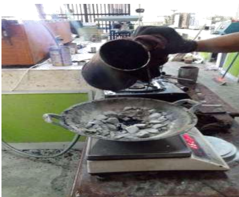
Proses Pencampuran Aspal Dan Agregat
