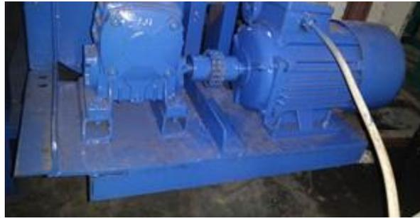
Gambar 4.6 Dudukan Motor Listrik dan *Gearbox*
