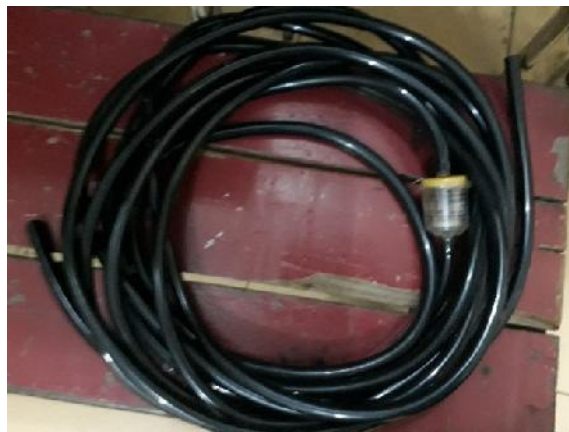
Gambar 3.6. Selang probe dengan filter probe
