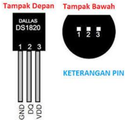
Gambar 2.6 Bentuk Fisik Sensor Suhu DS18B20(Sumber : https://kl801.ilearning.mez )
