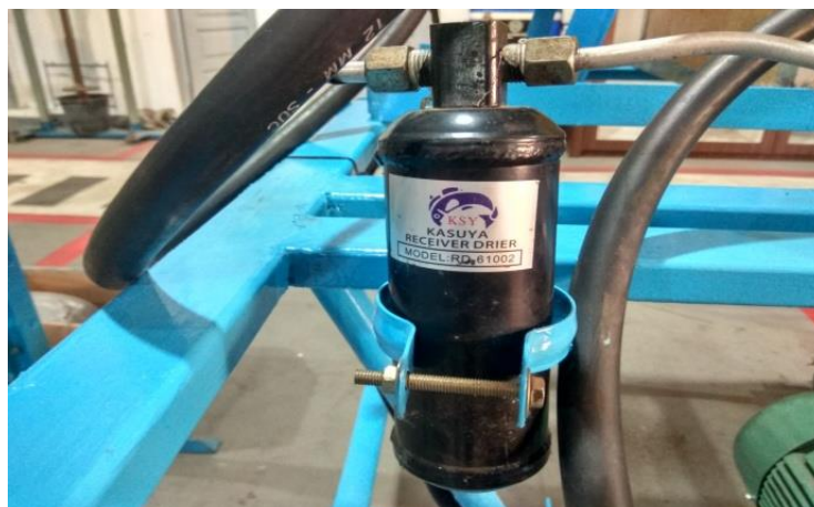
Gambar 3.6 Receiver Dryer Sebagai Penyaring
