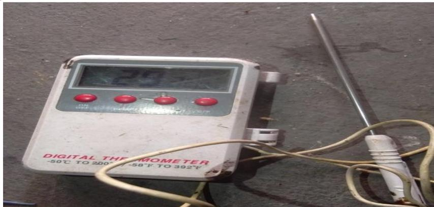
Gambar 3.11 *Digital Thermometer*
