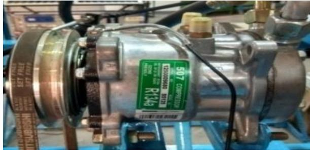
Gambar 2.2 Kompresor *swash plate*
