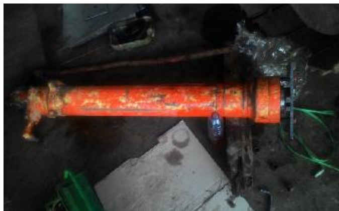
Gambar 3.10. Rumah Silinder Bucket
