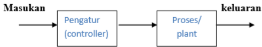
Gambar 2.1. Diagram alir sistem kendali loop terbuka (Syamsir A, 1998)
