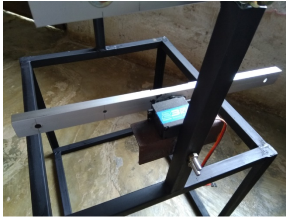
Gambar 3.30. Pemasangan motor servo
