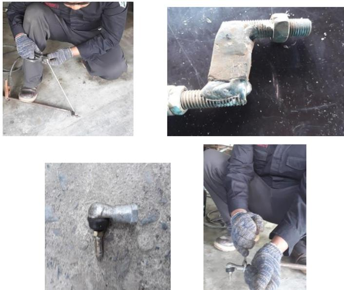
Gambar 54. Pelat pengunci *rack end* dan *tie rod*
