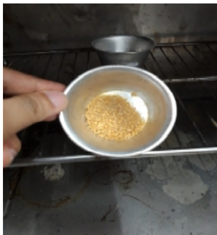
Endapan di masukan ke dalam oven dengan suhu 120^{\circ}\text{C} .
