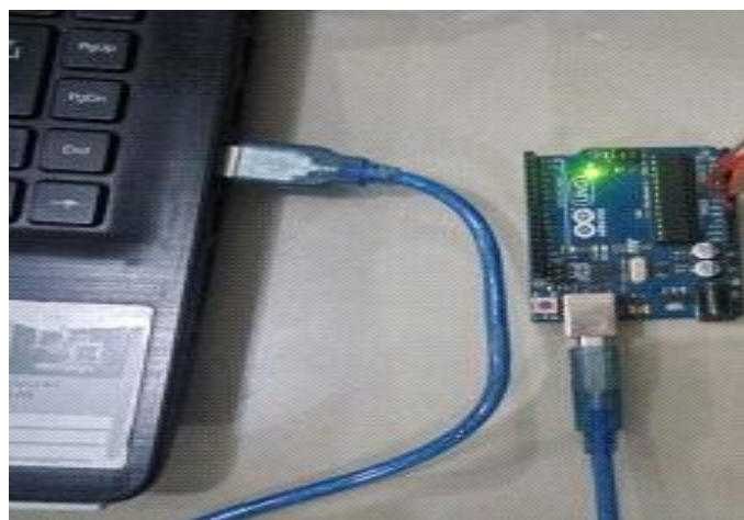
Gambar 3.8 hardware arduino disambungkan ke PC
