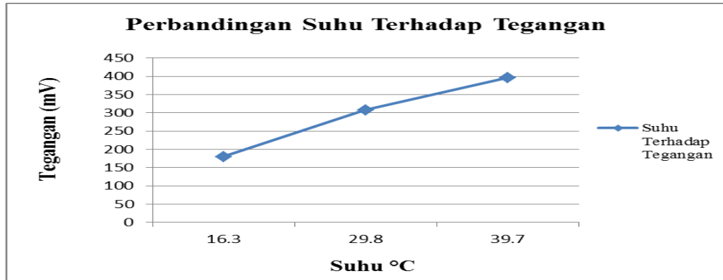
Gambar 4.19 Perbandingan Suhu terhadap tegangan bebelit pejal di panjang 70 cm
