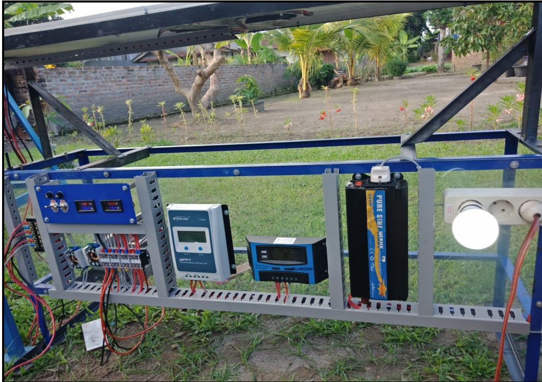
Gambar 3 Pengujian Sistem Pada Prototype PLTS
