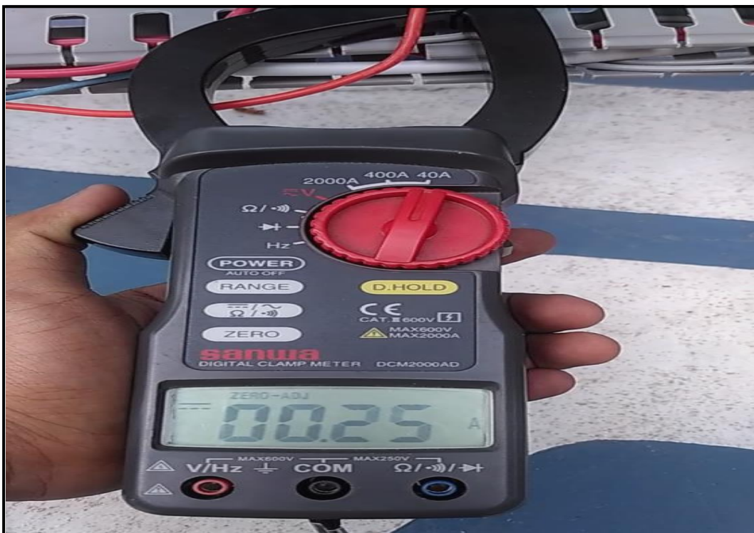
Gambar 4 Hasil Pengukuran Arus Masukan ( Input ) Yang Dihasilkan Oleh Panel Surya Dan Generator DC
