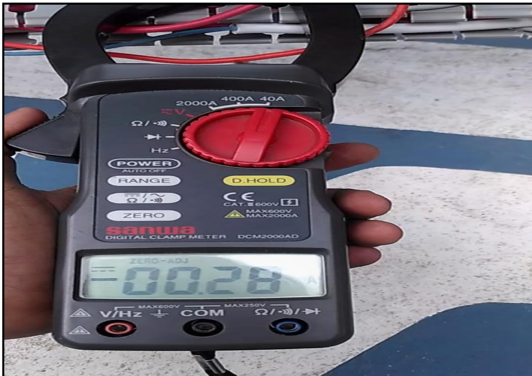
Gambar 6 Hasil Pengukuran Arus Keluaran ( output ) Yang Dihasilkan Oleh Solar Charger Controller PWM
