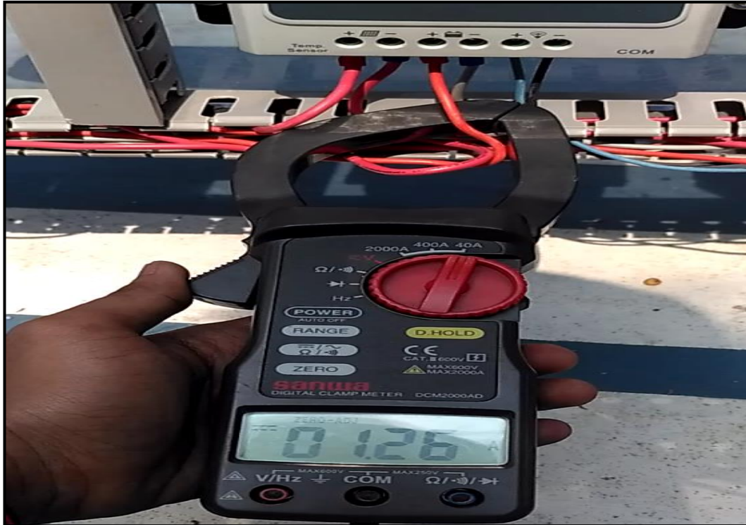
Gambar 5 Hasil Pengukuran Arus Keluaran ( output ) Yang Dihasilkan Oleh Solar Charger Controller MPPT
