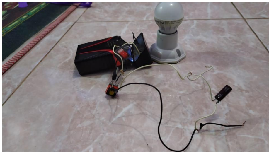
Gambar 3.7 Kotak Pelindung Joule Thief Mini Inverter untuk Melindungi dan Mempeindah tampilan dari Joule Thief Inverter
