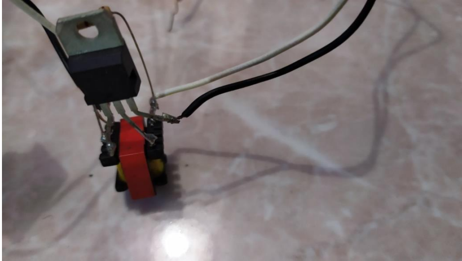
Gambar 3.8 Joule Thief Inverter sebagai penguat dan pengubah tegangan dari DC ke AC
