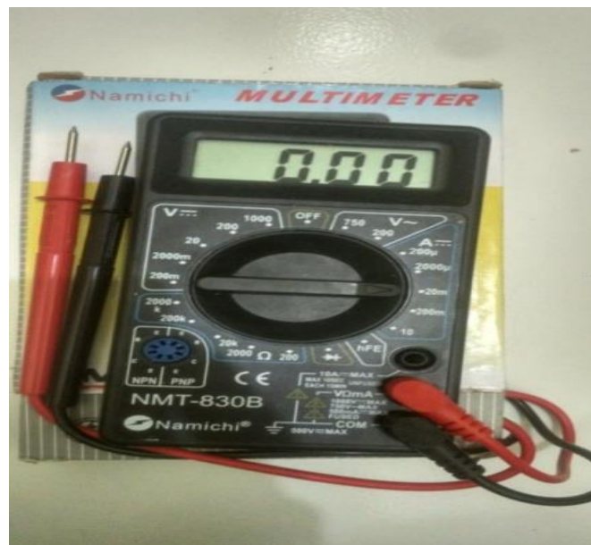
Gambar 3.3 Multimeter Digital Sebagai Alat Ukur Arus dan Tegangan yang Dihasilkan
