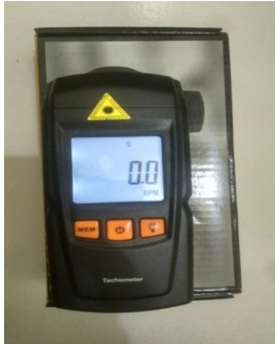
Gambar 3.4 Tachometer Digital Sebagai Alat Ukur Kecepatan Putaran Fly Wheel
