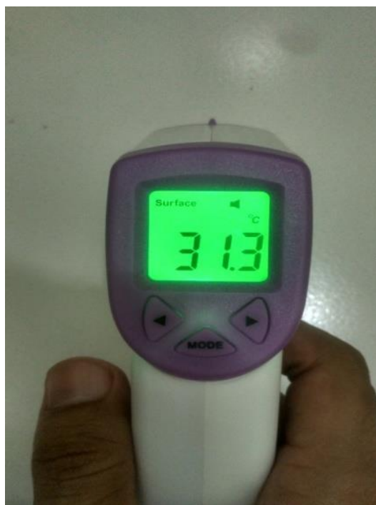
Gambar 3.5 Termometer Digital Sebagai Alat Ukur Temperature Hot / Th
