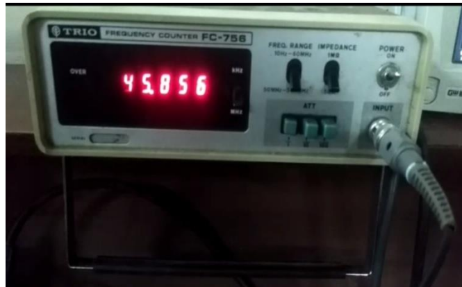
Gambar 4.1 Pengukuran Frekuensi Menggunakan Frequency Counter
