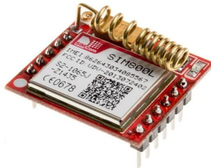
Gambar 2.9 Gambar modul sim 800 L
