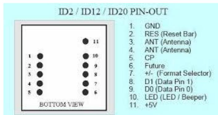
Gambar 2.5 konfigurasi pin pada modul RPID reader ID-12
