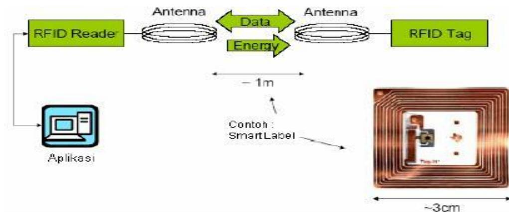
Gambar 2.6 Cara Kerja RFID
