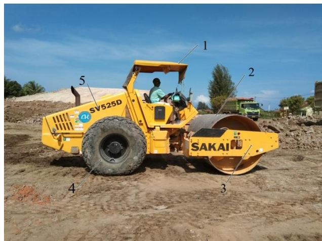
Gambar 2.7 Bagian-bagian *Vibrator Ruller* (Lokasi proyek, 2020)
