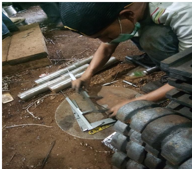
Gambar. 4.3. Mengukur plat besi yang akan dipotong
