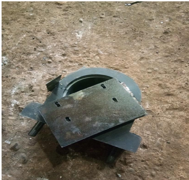
Gambar. 4.5. Hasil plat besi yang sudah dibor milling
