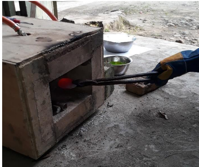
Gambar 3.19 Gambar Mengeluarkan Specimen Dari tungku pemanas
