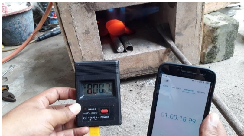
Gambar 3.18 Proses Pemanasan Specimen
