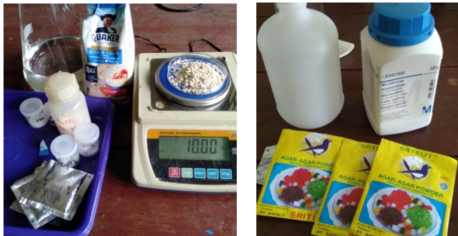
Gambar 9. Pembuatan media oat meal agar (OMA) dan media potato dextrose agar (PDA)
