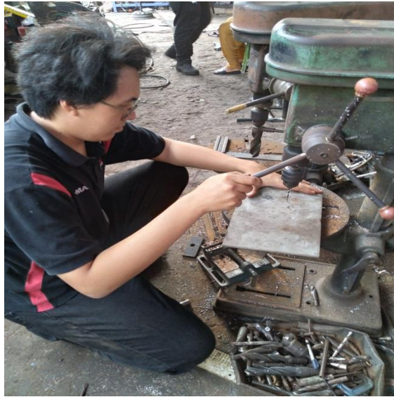
Gambar 4.14. Proses Pembuatan Lubang Pada Base Plate
