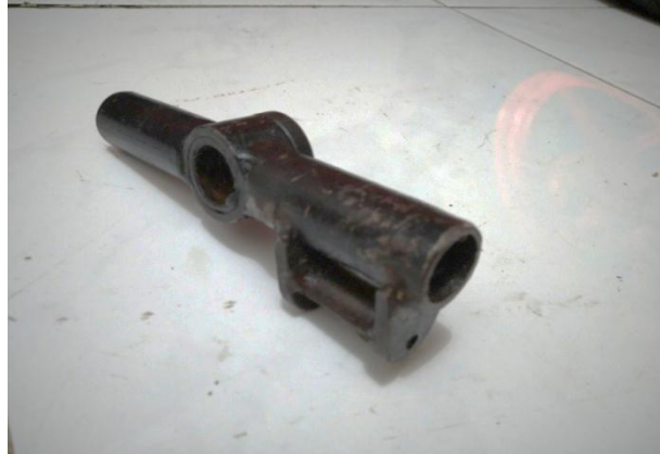
Gambar 4.29. Hasil Pembuatan Tuas Beban Tumpuan 1
