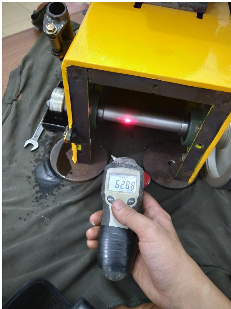
Gambar 4.37. Rpm Rotor Friksi Saat Freeload
