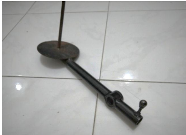
Gambar 4.30. Hasil Pembuatan Tuas Beban Tumpuan 2
