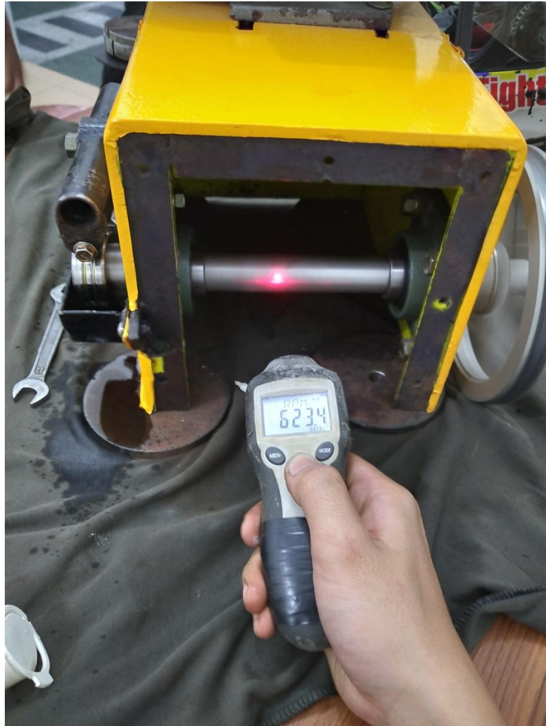
Gambar 4.38. Rpm Rotor Friksi Saat beban 10 Kgf diterapkan
