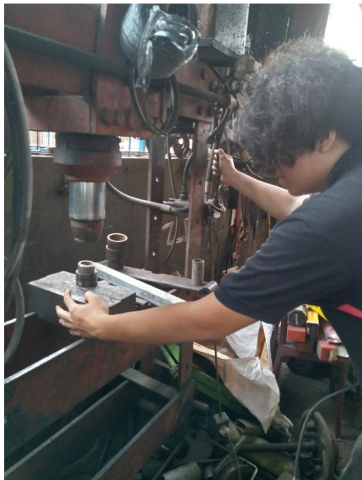
Gambar 4.21. Proses Penggabungan Rotor Friksi
