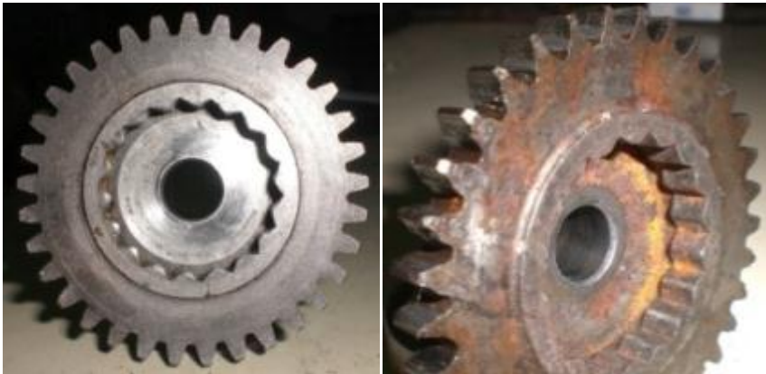
Gambar 2.2. Spesimen roda gigi normal dan aus
