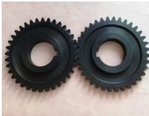
Gambar 3.14 Spesimen setelah di bubut
