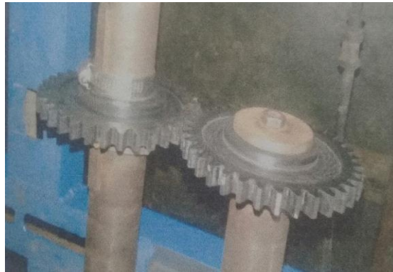
Gambar 4.1 Roda Gigi Lurus Sudah Diuji
