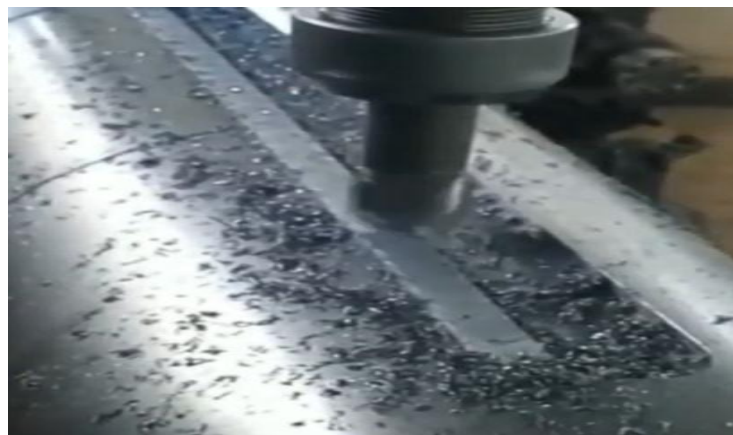
Gambar 4.15. Membuat Alur Pasak Pada Poros Dengan Proses Pengefraisan
