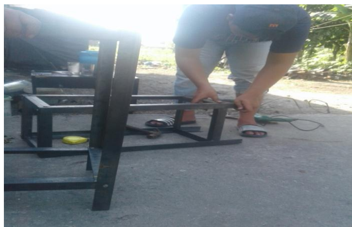
Gambar 4.17. Proses Perakitan Rangka Rumah Sistem Kontrol
