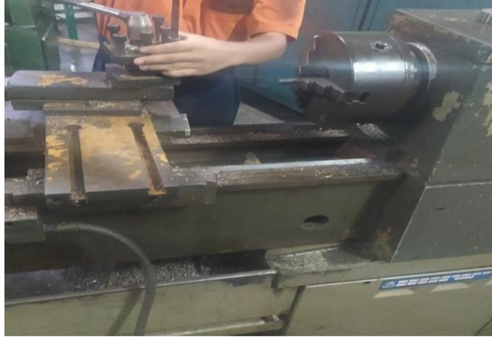
Gambar 4.3 Membubut Spesimen Uji
