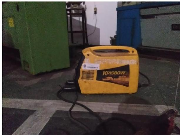
Gambar 3.2 Mesin Las SMAW (Las Listrik)
