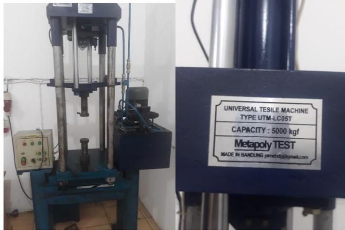
Gambar 4.8 Mesin uji tarik dan kelengkapannya
