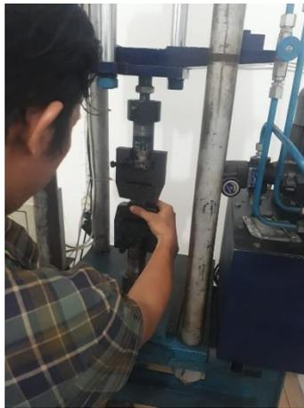
Gambar 4.11 Mengikat spesimen
