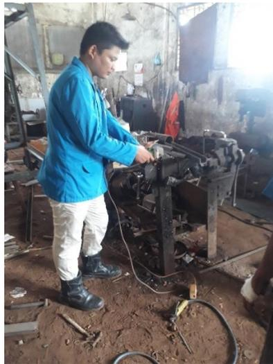
Gambar 4.2 Memotong Spesimen Uji
