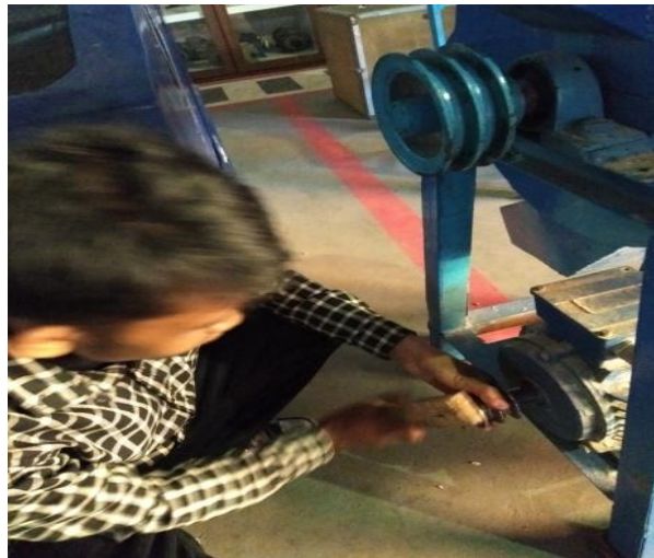
Gambar 3.13 Pemasangan pully diameter 63 mm
