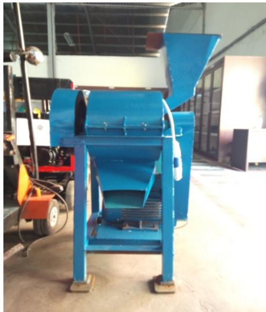
Gambar.2.1 Mesin penghancuran Limbah Kayu
