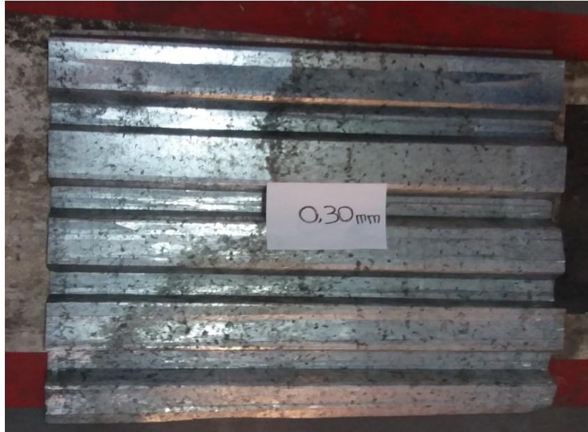
Gambar 4.11 Hasil pembuatan atap rumah dengan tebal 0,30
