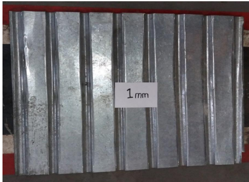
Gambar 4.2 Hasil pembuatan atap rumah dengan tebal 1 mm
