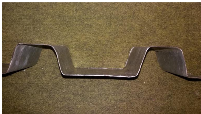
Gambar 4.9 Gambar hasil dari penekukan pada pelat 1mm
