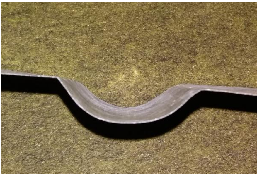
Gambar 4.6 Gambar hasil dari penekukan pada pelat 0.30 mm
