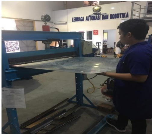
Gambar 3.11 Memasukan lembaran pelat kedalam die
