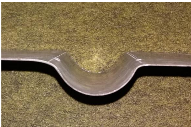
Gambar 4.3 Gambar hasil dari penekukan pada pelat 1 mm
