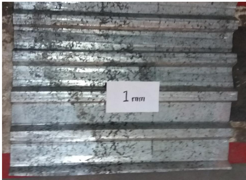
Gambar 4.8 Hasil pembuatan atap rumah dengan tebal 1 mm
