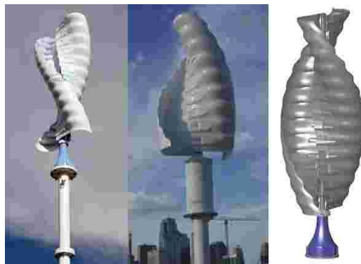
Gambar 2.3 Rotor Savonius berbentuk heliks. ( Heliks Win. 2006)
