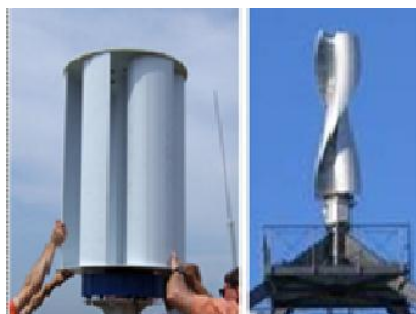
Gambar 2.1 Rotor tipe U dan Heliks (Admadi, S. 2008)
