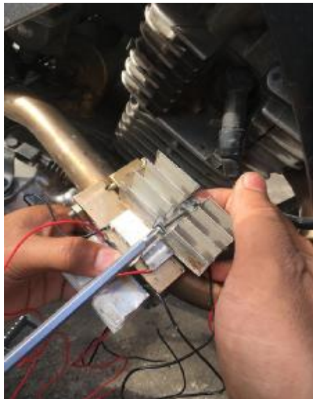
Gambar 3.23 Pemasangan pengikat heatsink
