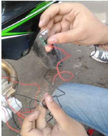
Gambar 4.9 Penyambungan kabel ke soket usb
