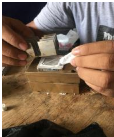
Gambar 4.5 Peletakan heatsink ke peltier
