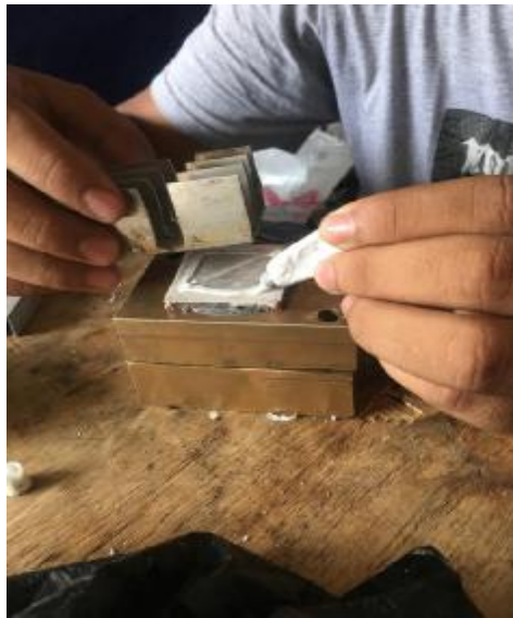
Gambar 3.21 Peletakan heatsink ke peltier
