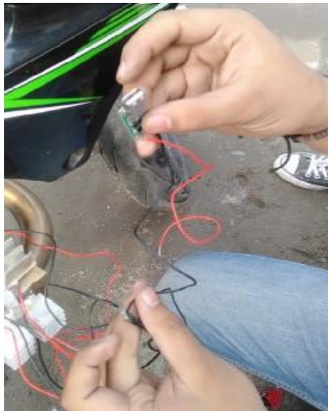
Gambar 3.25 Penyambungan kabel ke soket usb
