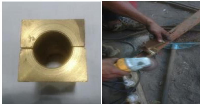
Gambar 4.3 Kuningan yang telah dilubangi dan dibelah menjadi dua bagian
