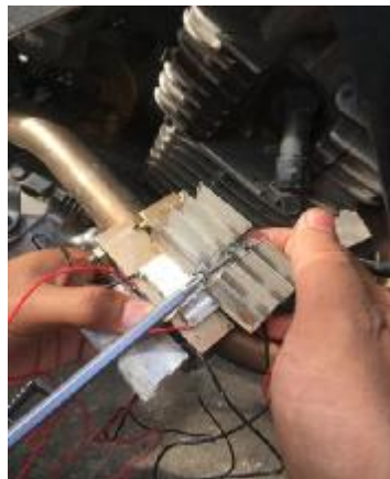
Gambar 4.7 Pemasangan pengikat heatsink
