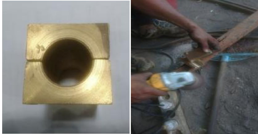
Gambar 3.19 Kuningan yang telah dilubangi dan dibelah menjadi dua bagian
