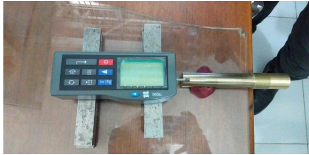
Gambar 3.9 Pada saat proses pengujian kekasaran permukaan
