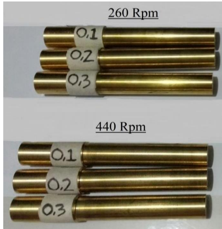
Gambar 4.6 Spesimen 01 0,20,3mm Kedalaman Penggerindaan Pada Kecepatan Putaran Spindle 260 Rpm Dan 440 Rpm.
