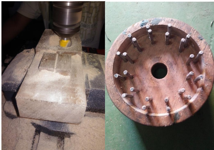
Gambar 3.24 Proses pembuatan cetakan Bucket dan cetakan Runner
