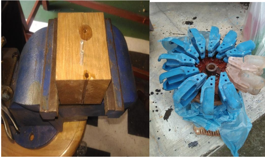
Gambar 3.25 Penuangan resin pada cetakan Bucket dan Runner
