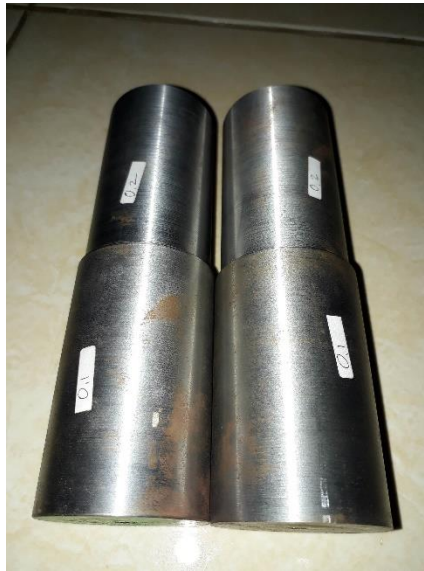
Gambar 4.1 Hasil pembubutan spesimen Baja ST 37
